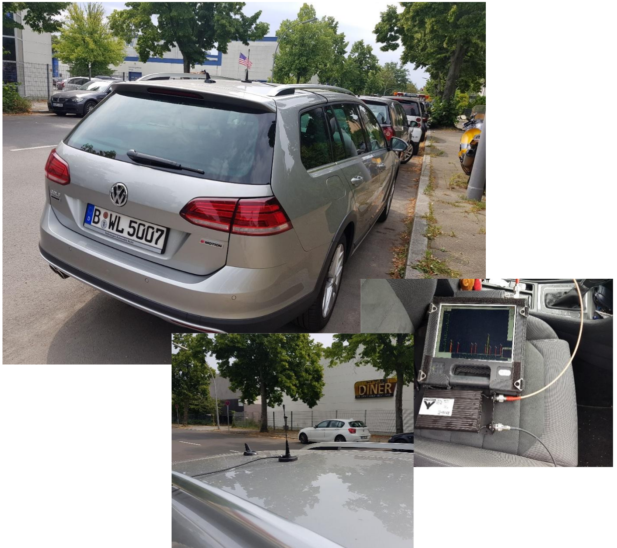
Beispiel Testaufbau für Ersterfassung örtliche BOS-Freifeldversorgung und Ausgangssituation
